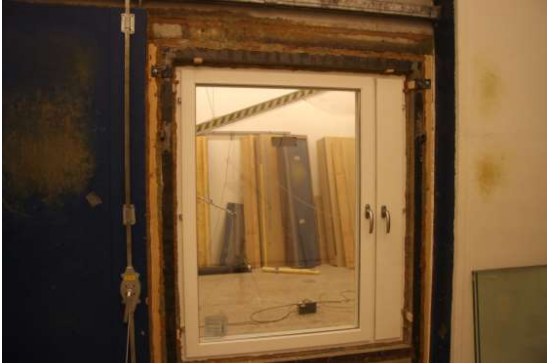
Bild 1 – Fönstret i bilaga 1, med vädringsluckan av 4 mm board på insidan.
