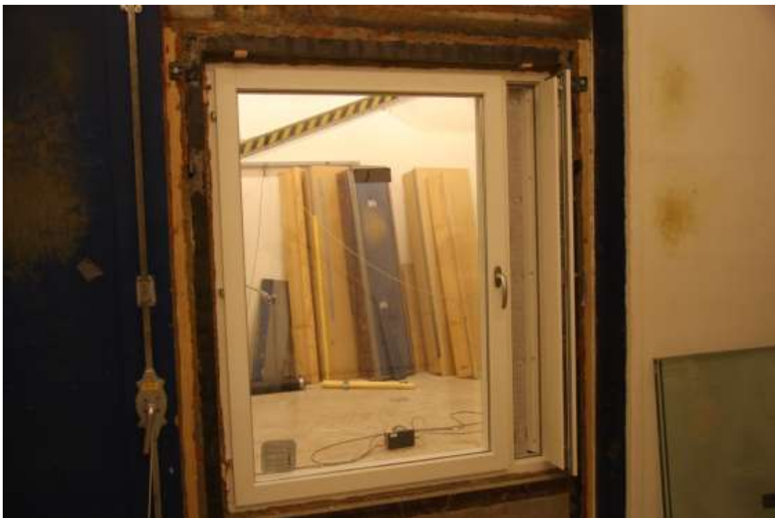
Bild 14 – Fönstret vid provningen med öppen vädringslucka.
