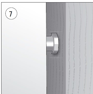
2.7 Karmhylsa OBS! Karmhylsan får ej dras så hårt att karmen böjer sig.
