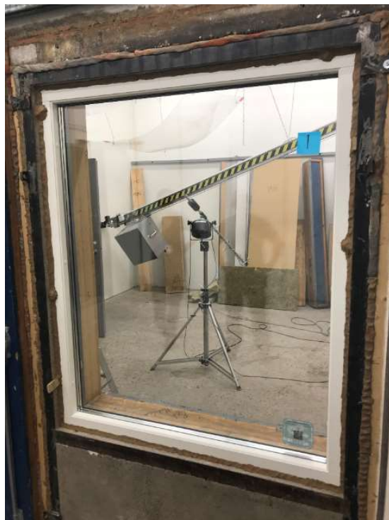
Figur 1 – Provobjekt sett från mottagarrummet.
